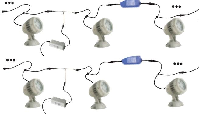
Bei entsprechenden Leitungslängen kann es erforderlich werden, weitere Leitungsverstärker und Controller zu installieren.
